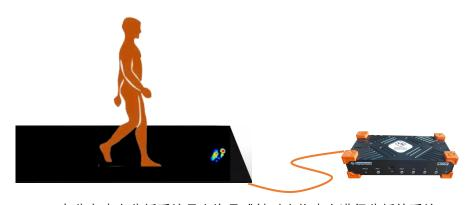
Forcemapping-GAIT 压力分布步态分析系统是上海邑成针对生物步态进行分析的系统,由 1-5 米长的可行走薄膜压力传感器步道+专业数据采集与步态分析软件组成。能够对任何接触面之间的压力分布进行静、动态测量。并将压力分布以 2D,3D 彩色云图显示压力分布数据和轮廓,以此分析人在站立或行走过程中的足底压力特性并进行分析。
